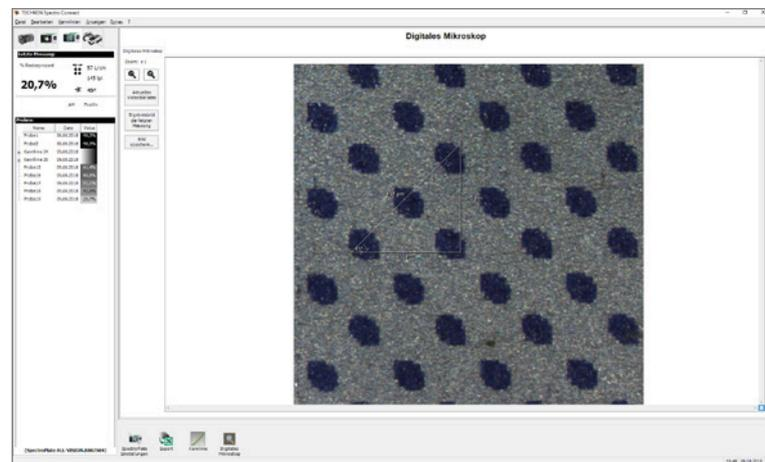
sche Präzisionsinstrument genauso souverän wie die Bestimmung der geometrischen Flächendeckung der Rasterpunkte im CMYK-Vierfarbdruck.
